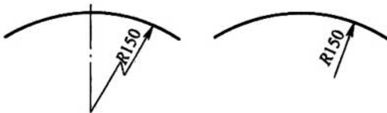
图 11. 4. 3 大圆弧半径的标注方法
