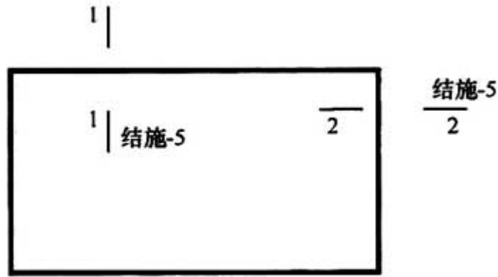
图 7. 1. 4-2 断面的剖切符号
